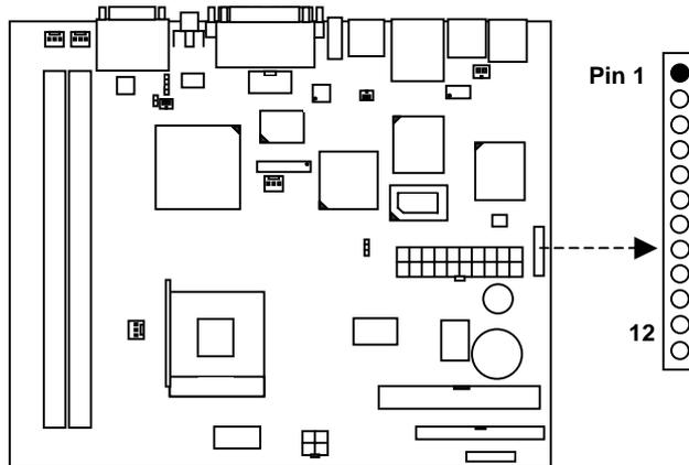
**CN6 : Mini-PCI Modem Card Connect Pin**
